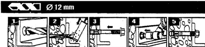
**Bild 1:** mit 12 mm Steinbohrer mind. 105 mm bohren.
