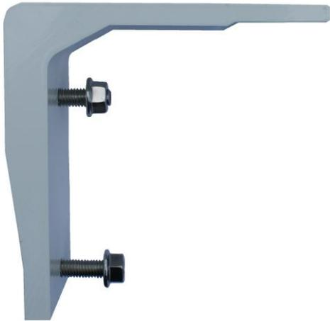
Bei der Deckenmontage darf die Markise möglichst nicht am äußersten Rand des Sturzes angebracht werden. Die Vorderkante der Konsole sollte mindestens 20 cm von der Vorderkante bzw. seitlichen Kante des Balkons/ der Decke entfernt sein. (Spreizwirkung der Dübel beachten)
