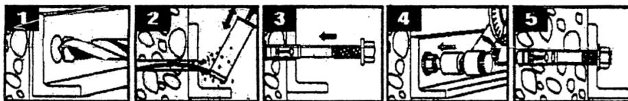
**Bild 1:** mit 12 mm Steinbohrer mind. 105 mm bohren.
