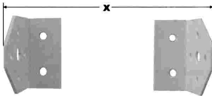
Zeichnen Sie nun mit Hilfe des Winkels die Bohrlöcher an und bohren mit einem Steinbohrer  $\varnothing 8$  mm die Löcher. Die beiden Winkel müssen waagrecht gegenüber sitzen (Schenkel nach innen zeigend).
